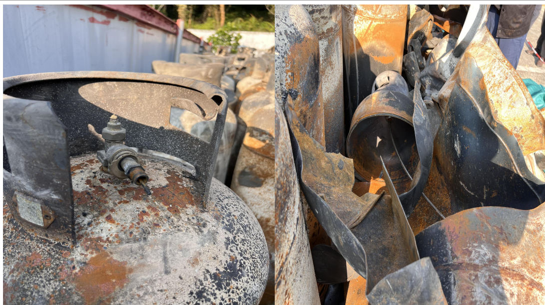
图 17、18 倒气的涉事气瓶（可见倒气管接头）及爆炸的气瓶
